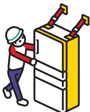
ベルト式器具で冷蔵庫の上部と壁を固定する。
